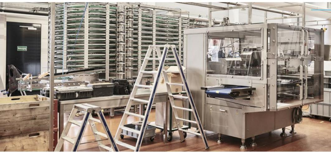
Der Lieferumfang beinhaltet eine Vorwärmspirale und eine Kühlspirale, eine Giessmaschine Alpha CAD sowie eine Alpha X in der Nuss-I-Hybridausführung, mehrere Vibrations-tische mit vertikaler und horizontaler Vibration und einen Formenabstapler sowie Lifter für Trichter und Düsenplatten für beide Giessmaschinen.
